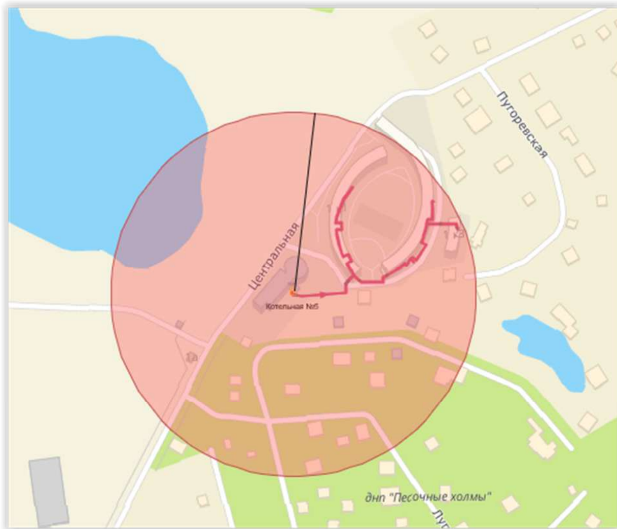
Рисунок 93. Радиус эффективного теплоснабжения котельной №5
