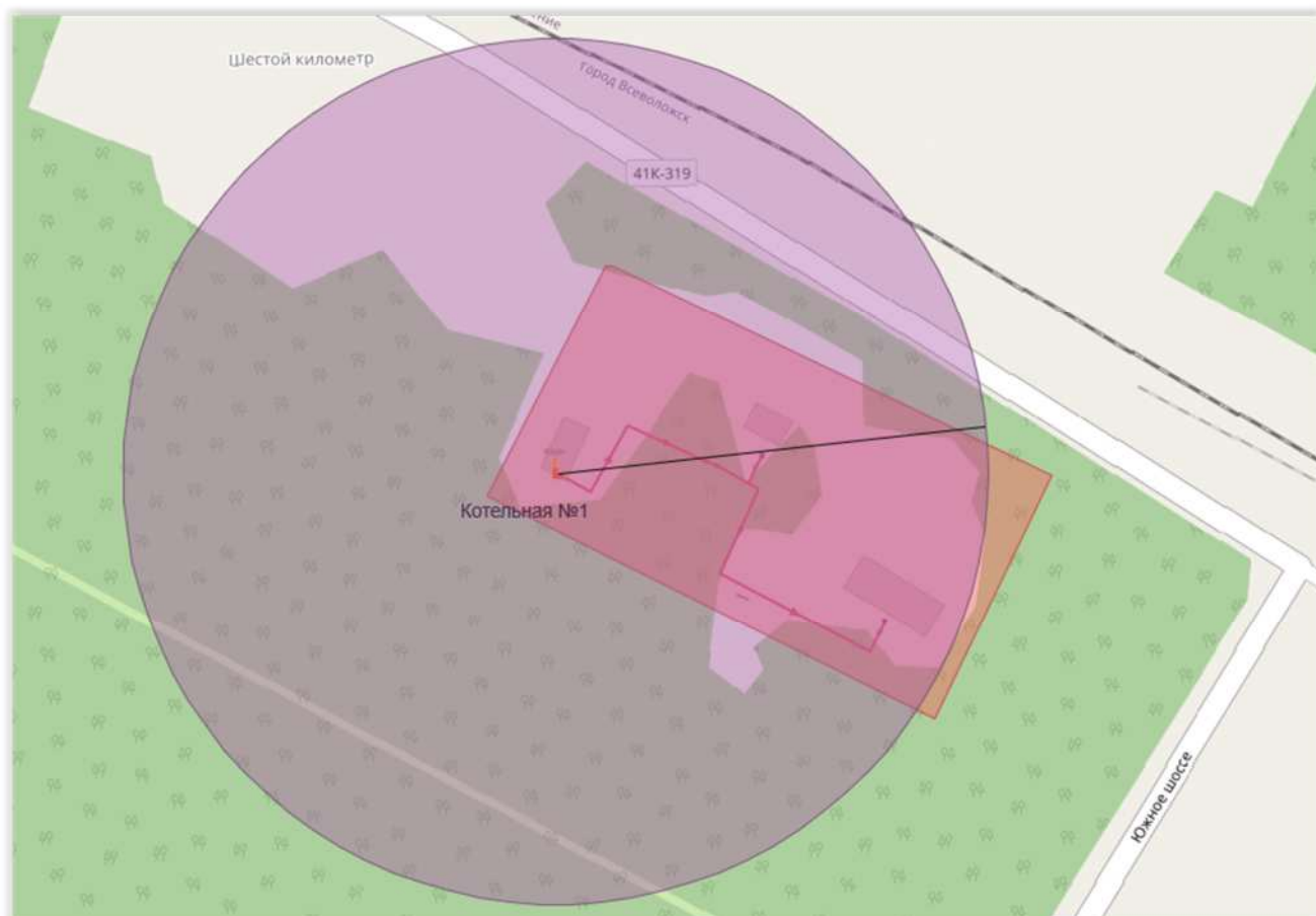
Рисунок 18. Радиус эффективного теплоснабжения котельной №1
