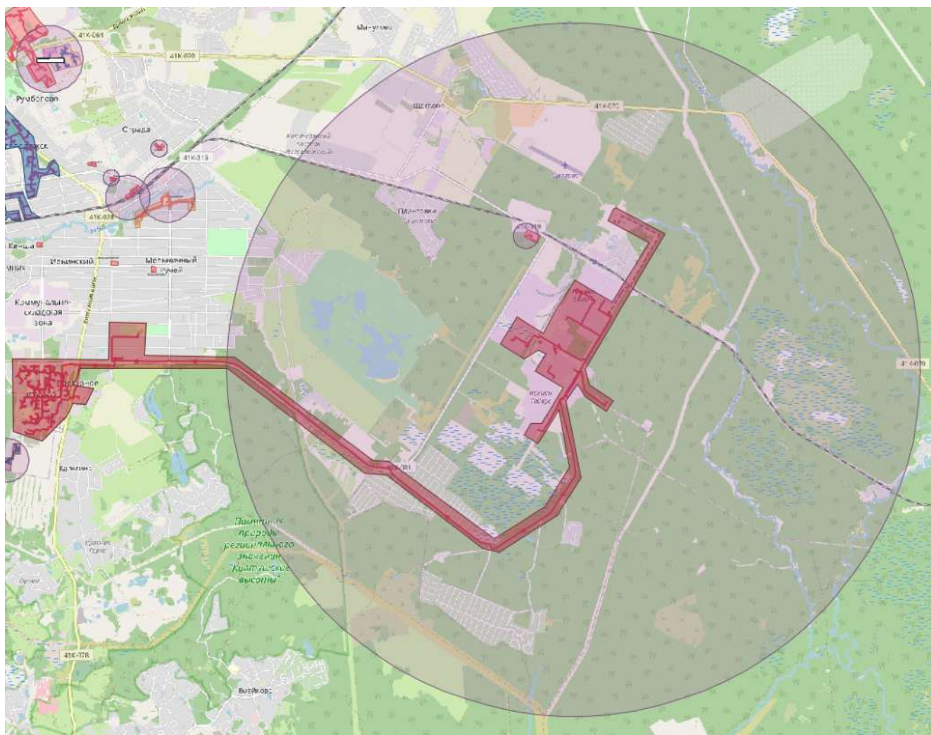
Рисунок 96. Радиус эффективного теплоснабжения котельной №17
