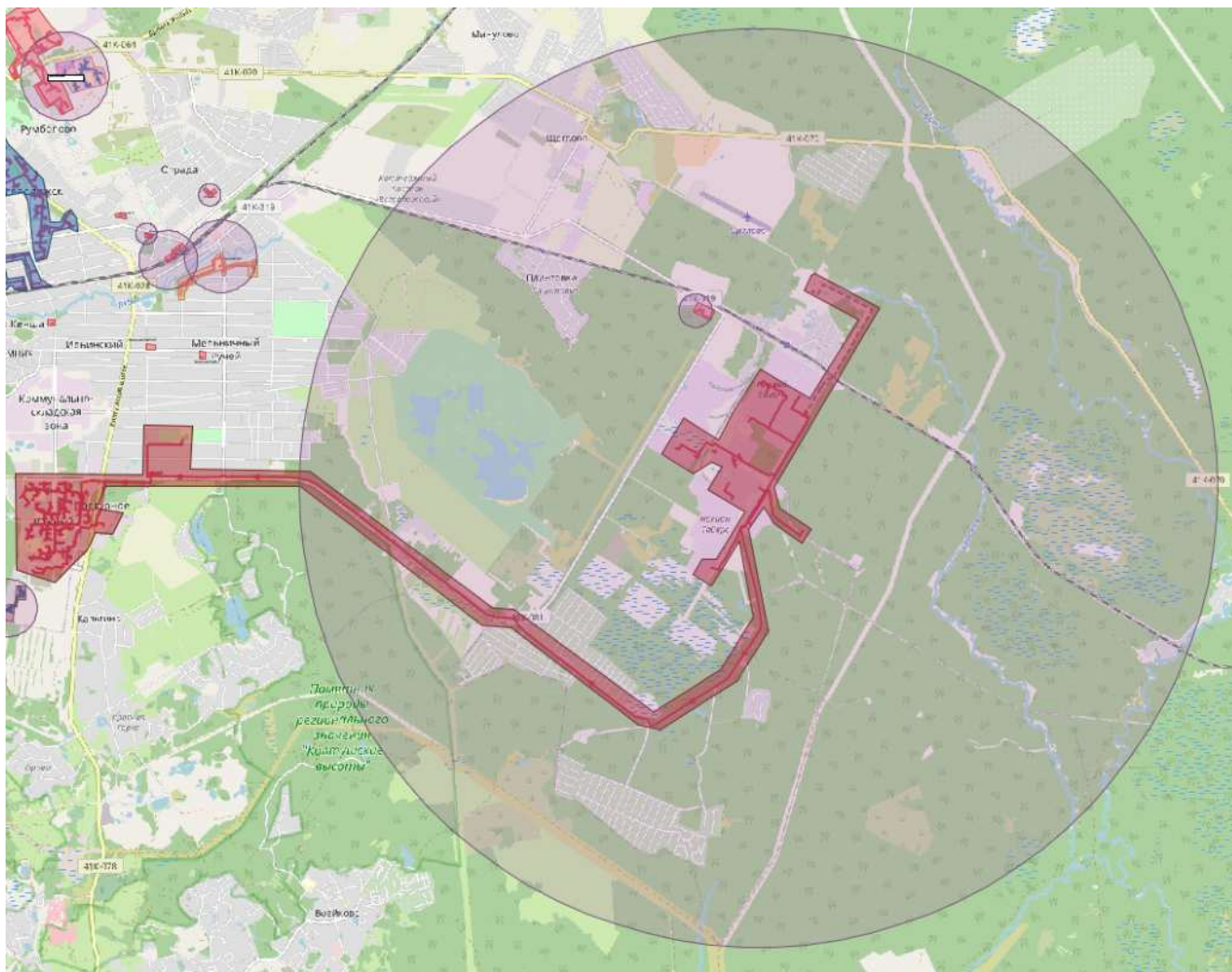
Рисунок 25. Радиус эффективного теплоснабжения котельной №17
