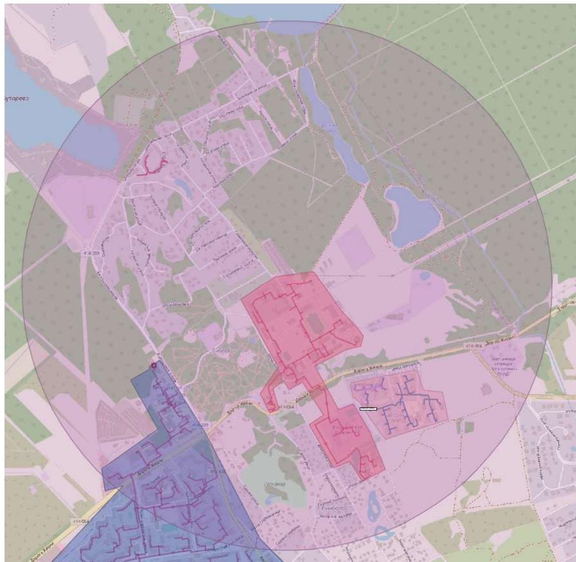
Рисунок 24. Радиус эффективного теплоснабжения котельной №12
