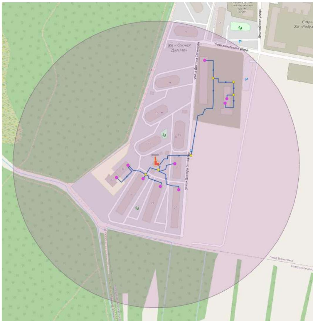
**Рисунок 30. Радиус эффективного теплоснабжения котельной ООО «Бис Мелиор Трейд»**
