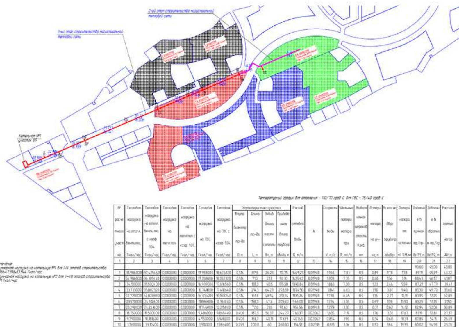
Рисунок 39. Первая зона действия теплоснабжения, снабжаемая тепловой энергией от котельной №1
