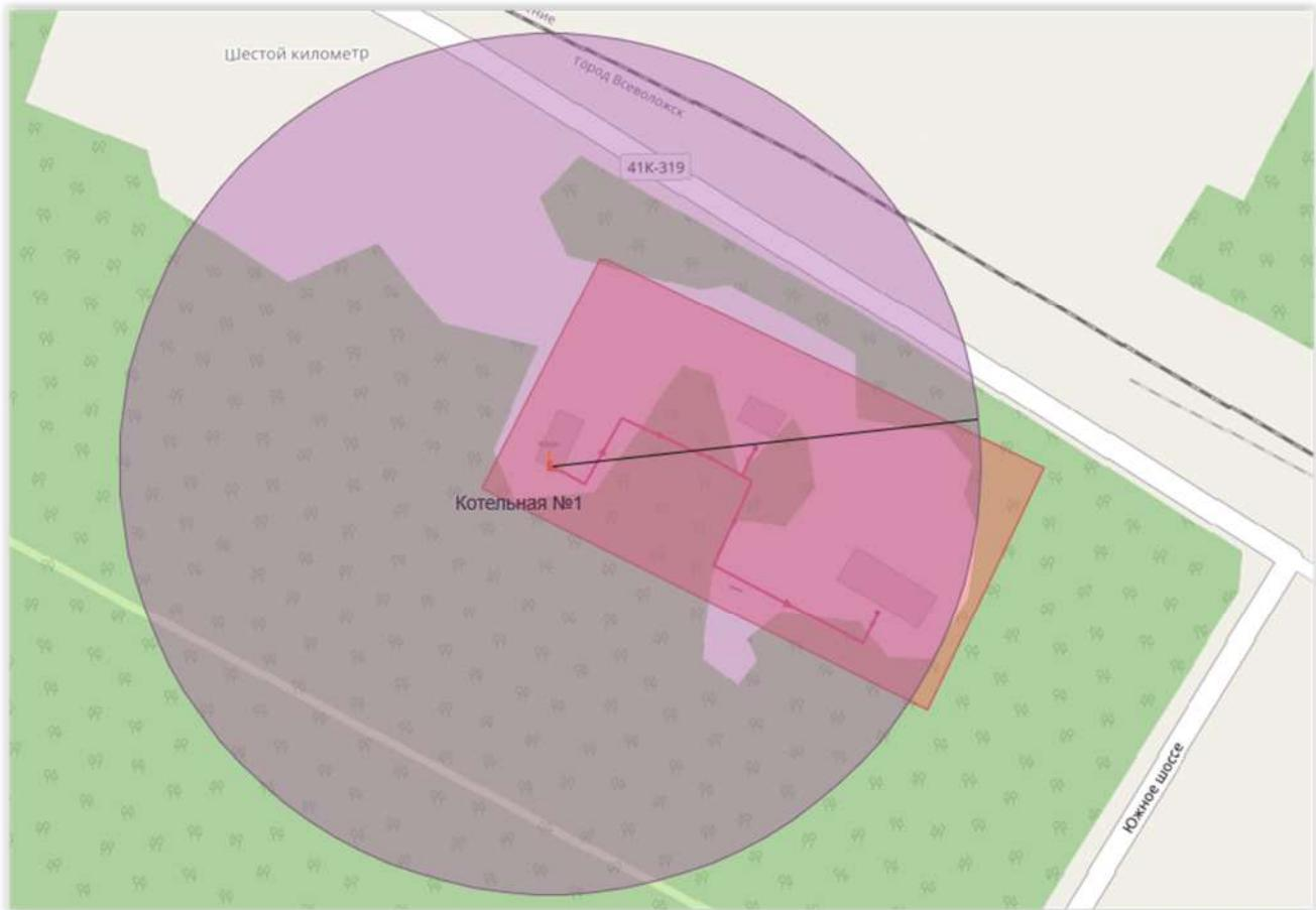
**Рисунок 18. Радиус эффективного теплоснабжения котельной №1**
